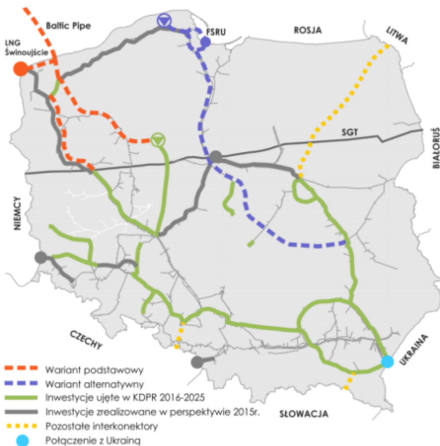
Dwa warianty budowy Korytarza Północnego. Fot. gaz-system.pl
