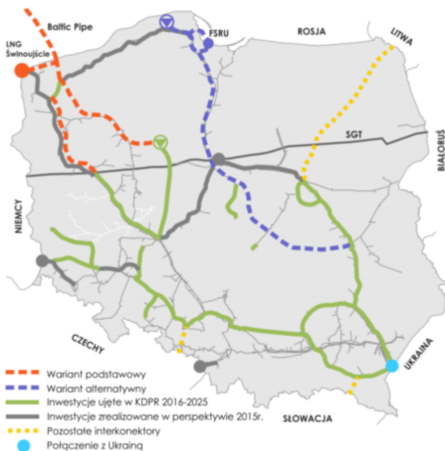
Dwa warianty budowy Korytarza Północnego. Fot. gaz-system.pl
